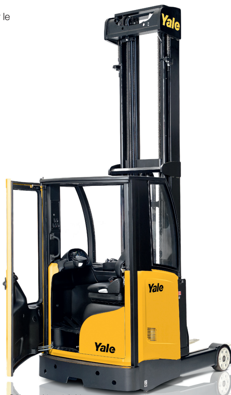
Cabina completamente isolata con vetri riscaldati e dotata di riscaldamento.
